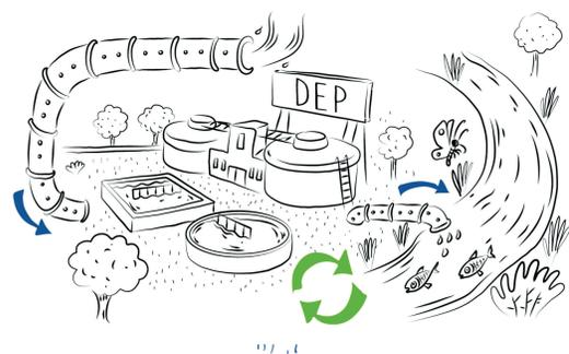
COME FUNZIONA UN IMPIANTO DI DEPURAZIONE? L'ACQUA PASSA ATTRAVERSO VARIE FASI: GRIGLIATURA E STACCIATURA - DISSABBIATURA/DISOLEAZIONE - SEDIMENTAZIONE PRIMARIA - TRATTAMENTO SECONDARIO
